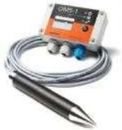
Le système d'alarme surveille l'état de commutation d'un détecteur de niveau d'huile. La mesure est réalisée par différence de conductivité entre l'eau et les hydrocarbures.
